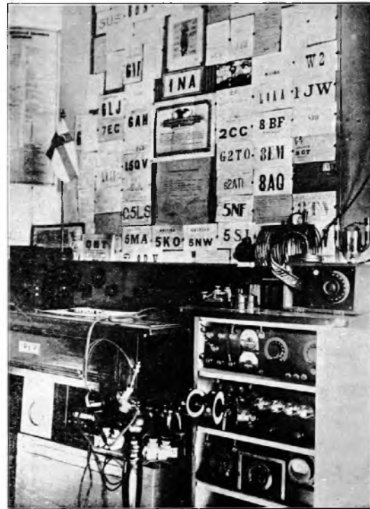
Op de tafel van links naar rechts bevinden zich de 8 lamps korte-golf super-heterodyne ontvanger, zender en golfmeter. Onder den zender zijn de transformatoren, stroom-contrôle en de lange-golf ontvanger. Nog even is de zendlamp zichtbaar tusschen den muur en de spoel.
